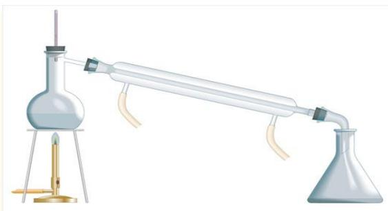
Aparato de destilación. La disolución que se desea separar se coloca en el balón de la izquierda. El componente de menor punto de ebullición pasa al estado gaseoso, se condensa en el refrigerante (tubo central) y se recoge por separado en el matraz de la derecha.
